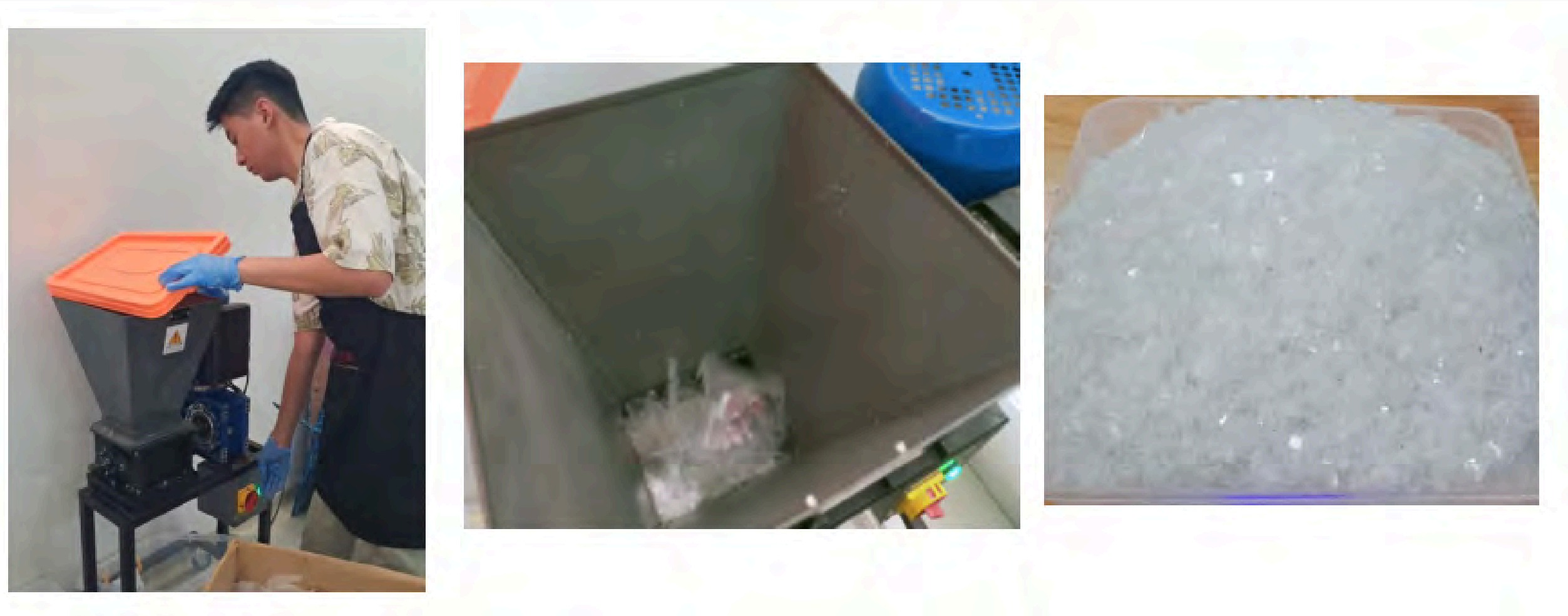
Gambar 2. Proses Pencacahan Limbah Plastik PP dan Hasil Cacahan
