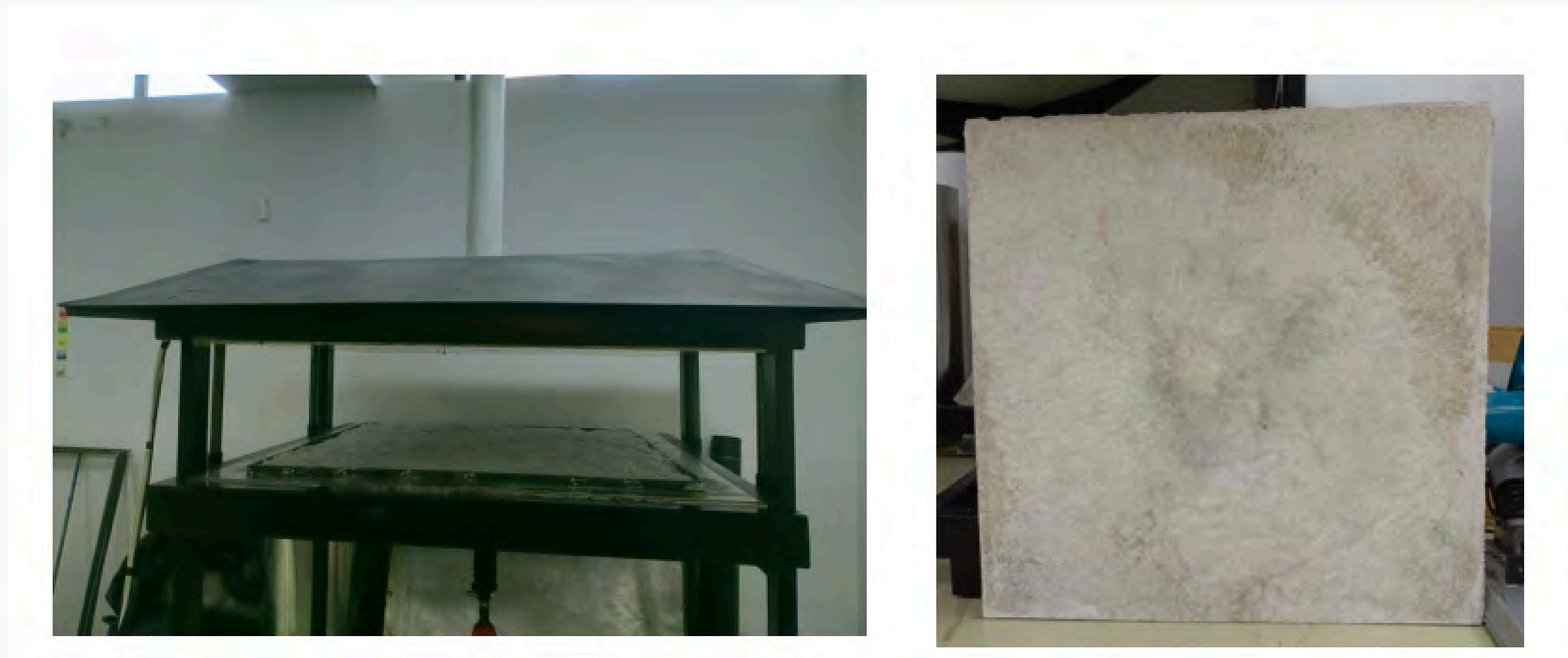
Gambar 3. Cacahan Plastik PP thin wall pada Mesin Sheetpress dan hasilnya
